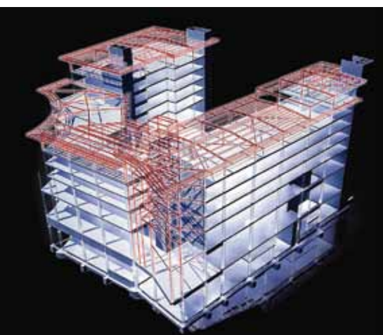
Ein BIM-Modell wurde hier zu einer Grafik umgearbeitet. Diese erlaubt es, mögliche strukturelle Schwachstellen zu erkennen und die Gesamtkosten abzuschätzen.
